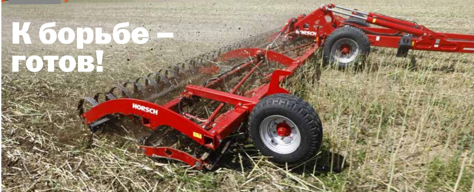
**В этом году на выставке Agritechnika компания Horsch представит новинку 2020 года — двойной каток-измельчитель Cultro TC. Агрегат предназначен для обработки стерни рапса, подсолнечника, кукурузы и заделки сидератов.**
