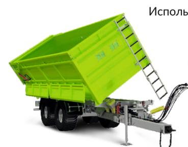
Используется для транспортировки всех сельско-хозяйственных грузов (корнеплоды, зерно, удобрения, и т.д.). Имеет возможность передвижения по любым дорогам и выгрузкой материала на три стороны, угол опрокидывания кузова при выгрузке, назад 50°, боковая выгрузка 30°.
